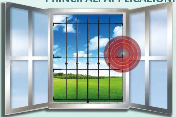
In presenza di una grata esterna, può essere sufficiente l'utilizzo di un solo sensore, questa volta montato in posizione verticale, in prossimità di una delle zanche.
