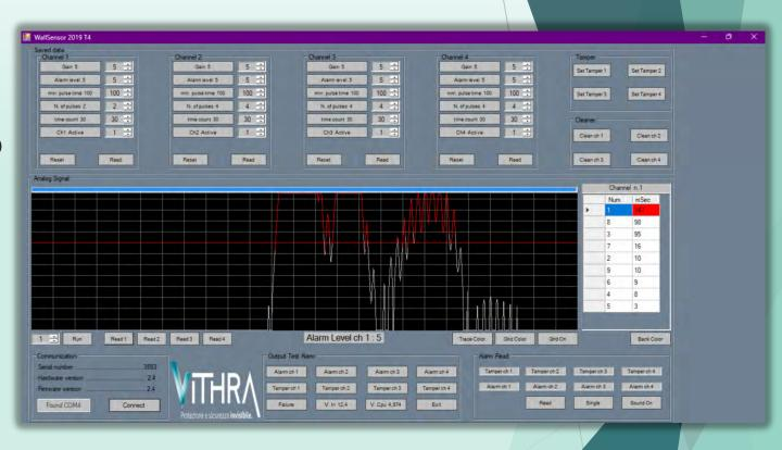
A calibrazione eseguita, verificare il buon funzionamento dell'impianto mediante dei test di allarme e di manomissione per ciascuno dei 4 canali. Il software è fornito gratuitamente.
